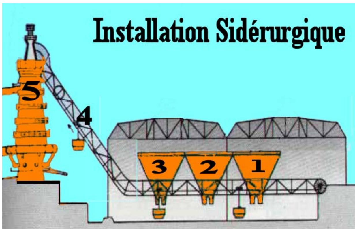
**1/ Déversoir du fondant :** c'est la matière incorporée dans la fonte pour abaisser sa température de fusion. Un fondant calcaire est employé dans les hauts-fourneaux lorsque le minerai de fer contient une trop forte proportion d'argile (carbonate de calcium  $\text{CaCO}_3$ ).
