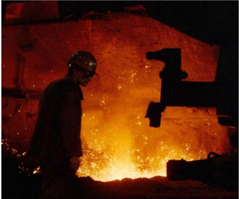
fourneau et devient de la fonte avec un taux de carbone supérieur à 2,1%. Cette carburation du fer abaisse sa température de fusion et on peut extraire du métal liquide. Un haut-fourneau moderne peut fournir plus de 10 000 tonnes de fonte par jour. Cette fonte est par la suite affinée par chauffage pour une décarburation qui permet d'obtenir des aciers et des dérivés ferreux.
