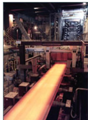
solidifiée à cœur qui est débitée en tronçons de la longueur désirée (brames). Ces brames sont ensuite transformées en bandes de tôle, par laminage à chaud.
