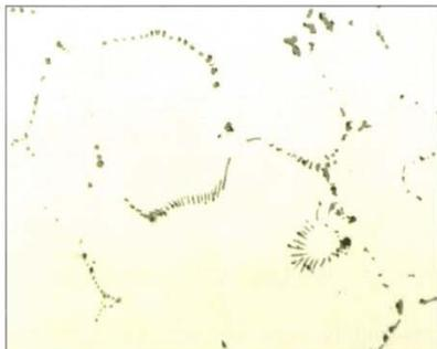
Fig. 3 : Type II - Microinclusions de sulfures dans les aciers
