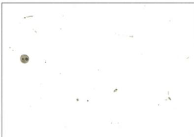
Fig. 2 : Type I - Microinclusions de sulfures dans les aciers
