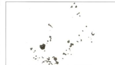
Fig. 8 : Microprecipitates d'oxydes du type B : alumine en grappes (x100)
